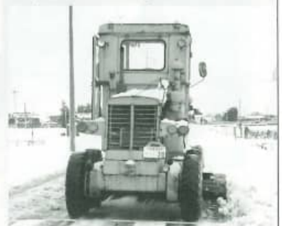
グレーダーによる除雪作業のようす
