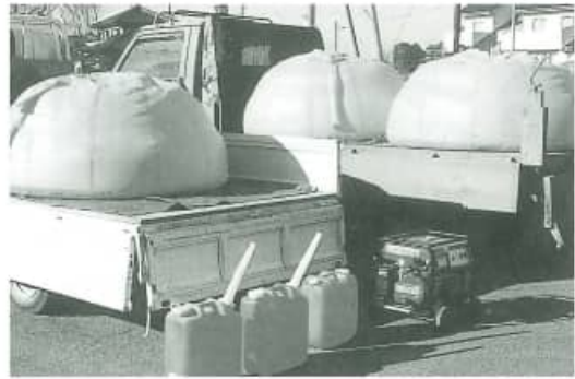
備えられた風船式給水タンク
